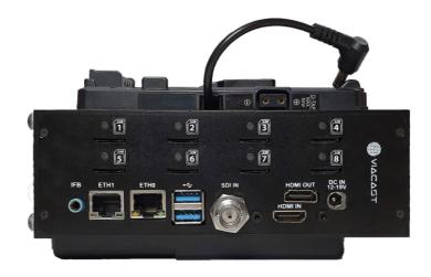
O LIVECAST PRO é altamente portátil e pode ser acoplado diretamente ao plate da câmera. A nova tecnologia proprietária de balanceamento empregada na nova geração de LIVECASTs oferece baixa latência e qualidade de imagem excepcional utilizando o método de compressão H.265 (HEVC). É possível trabalhar com até 36 conexões simultâneas usando redes 3G/4G/LTE, LAN (Ethernet), Ka /Ku e BGAN, garantindo suporte aos mais variados formatos de streaming.
